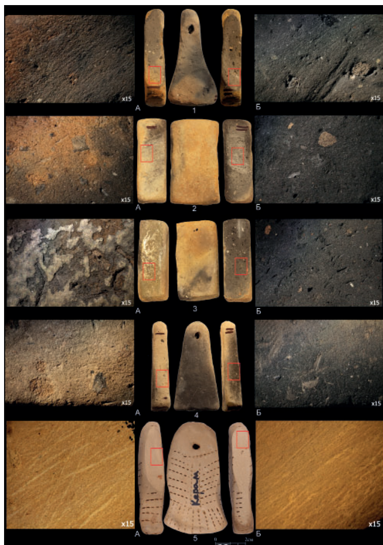
Рис. 9. Экспериментальные керамические бруски. 1 – брусок для обработки камня: А – микрофото следов сработанности по сухой поверхности, Б – микрофото следов сработанности по мокрой поверхности; 2 – брусок для обработки кости: А – микрофото следов сработанности по сухой поверхности, Б – микрофото следов сработанности по мокрой поверхности; 3 – брусок для обработки бронзы: А – микрофото следов сработанности по сухой поверхности, Б – микрофото следов сработанности по мокрой поверхности; 4 – брусок для обработки дерева: А – микрофото следов сработанности по сухой поверхности, Б – микрофото следов сработанности по мокрой поверхности; увеличение \times 15 ; 5 – брусок для обработки поверхности глиняного сосуда: А – микрофото следов сработанности по сухой поверхности, Б – микрофото следов сработанности по мокрой поверхности; увеличение \times 15 .
