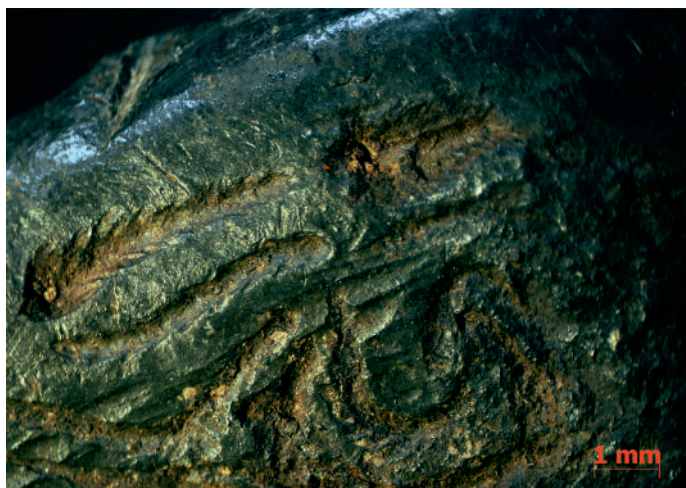
Рис. 3. Продукты коррозии в углублениях гравированного орнамента.
