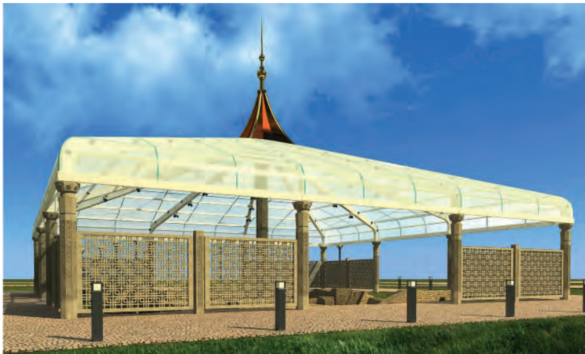
Проект музеефикации объекта с использованием защитного купола из поликарбоната Поликарбонаттан эшлэнгән саклау гөмбәзе белән объектны музейлаштыру проекты
