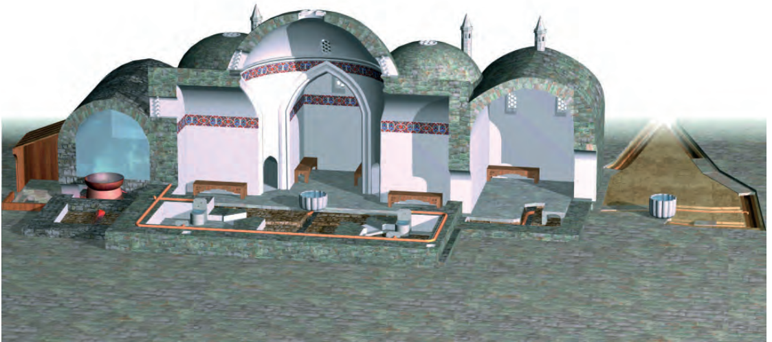
Баня № 2 в разрезе с демонстрацией основных помещений и коммуникаций (рис. 148–150 по И. Артамонову и А. Леухину)
