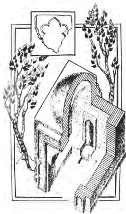
Аксонометрия и схема частичной реконструкции Южного здания Көнъяк бинаның аксонометриясе һәм өлешчә реконструкция схемасы
