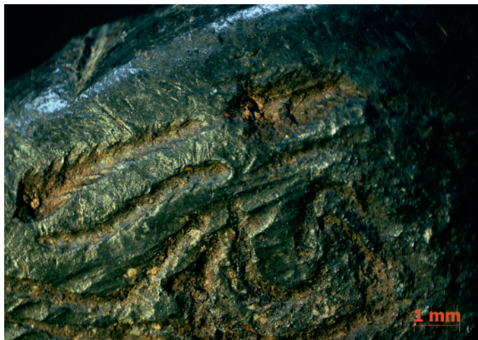
Рис. 3. Продукты коррозии в углублениях гравированного орнамента.
