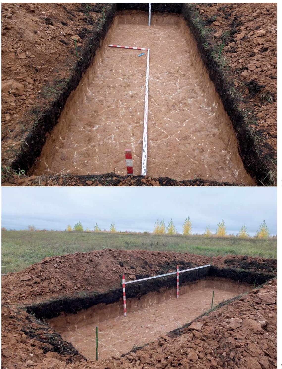
Рис. 11. Шурф 1, фото. 1 – после завершения уплотнение грунта на месте аномалии (-90 от 0); 2 – общий вид южной стенки шурфа
