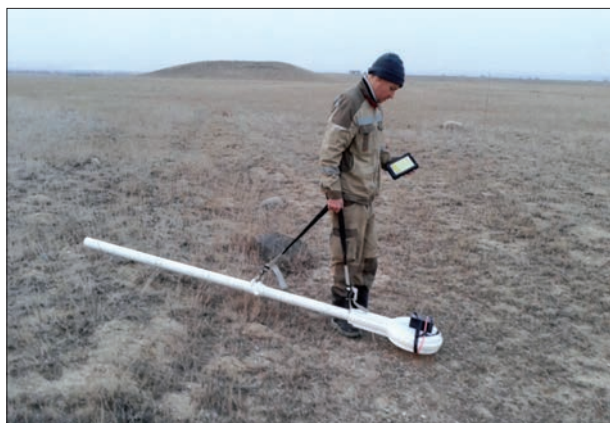
Рис. 5. Аппаратура электромагнитного профилирования «АЭМП-14»
