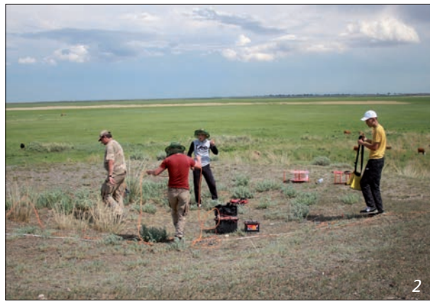
Рис. 7. Электроразведочная станция «СКАЛА-48». Расстановка ЭР кос и электродов
