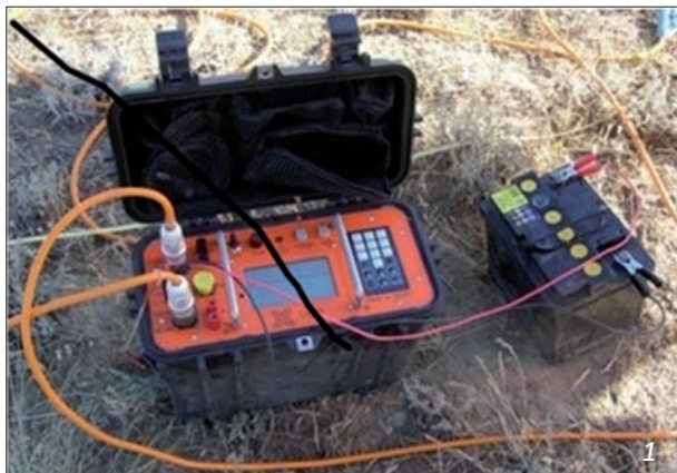
Рис. 7. Электроразведочная станция «СКАЛА-48». Расстановка ЭР кос и электродов
