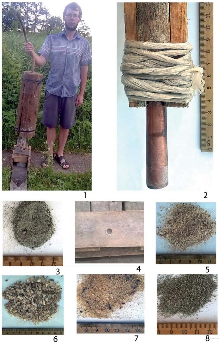
Рис. 1. Экспериментальные приспособления и исходные материалы для сверления. 1 – С.В. Грехов с коловоротом; 2 – крепление сверла (медной трубки) в коловороте; 3 – абразив из гранодиорита; 4 – фиксатор; 5 – абразив из мелкодробленого кварца; 6 – абразив из крупнодробленого кварца; 7 – абразив из мелкозернистого речного песка; 8 – абразив из мелкозернистого наждака
