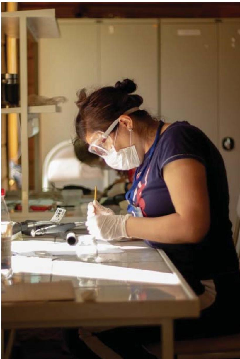
**Рис. 6.** Слушатель секции «Стабилизация и консервация археологического железа» за расчисткой археологической находки из железа
