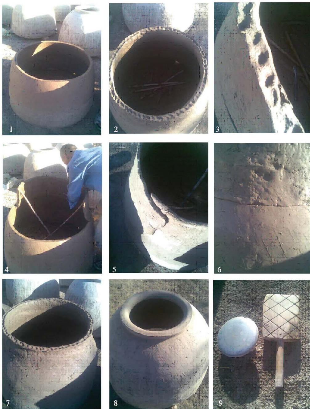
Рис. 9. Процесс формовки тандыров.
