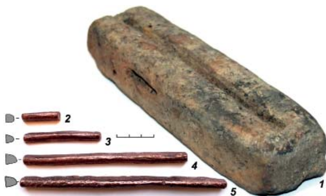
Рис. 2. Глиняная литейная форма с городища Анюшкар (1) и экспериментальные латунные слитки, отлитые по слепкам из формы (2–5).
