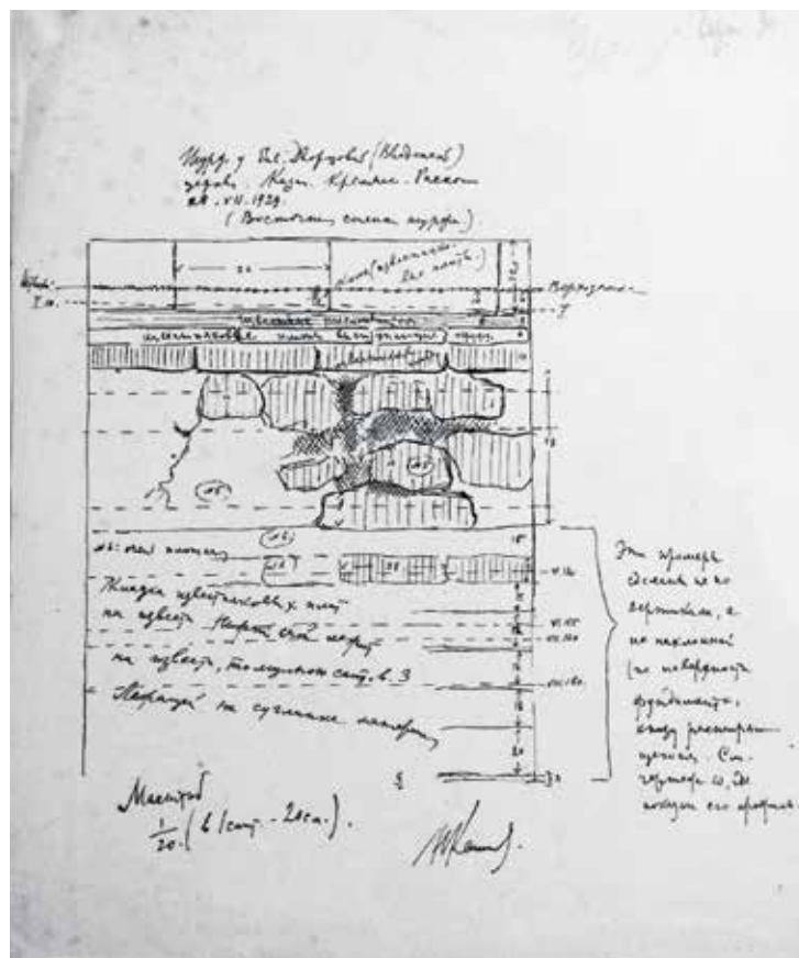
Рис. 75. Казань. Бумага, тушь. 1929 г. Казанский кремль. Шурф у западной стены церкви Введения. Стратиграфия. Чертеж Н. Ф. Калинина (АРАН. Ф. 2181. Оп. 1. Д. 758. Л. 4).
