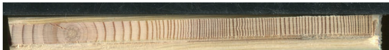
Рис. 1. Внешний вид зашлифованного керна, взятого с бревна TR №03.
