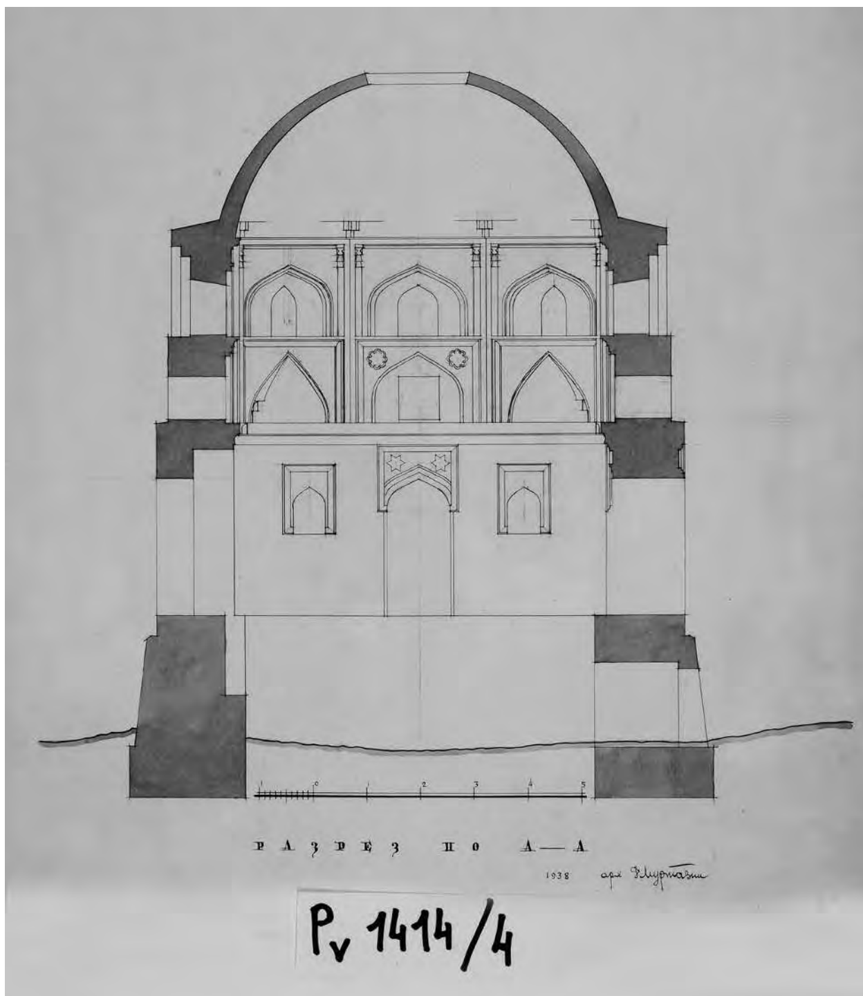
Рис. 1016. Болгар. Калька, тушь. 1938 г. Черная палата. Разрез. Обмер арх. Д. Муртазина (ГНИМА. Рv 1414-4).
