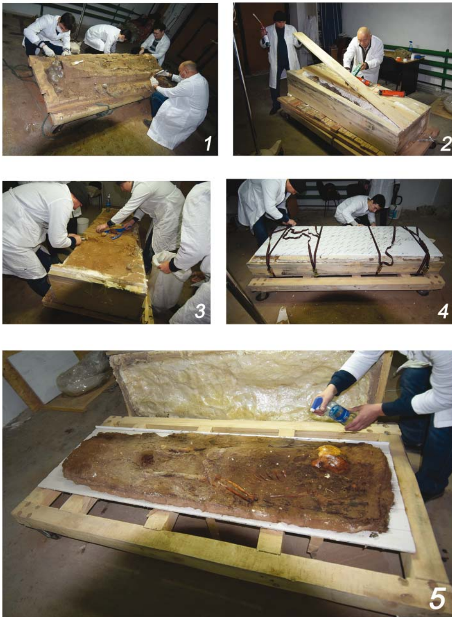
Рис. 7. Подготовка блока с погребением золотоордынского периода к томографическому исследованию. 1 – блок после вскрытия (верх); 2 – устройство кожуха из монтажной пены; 3 – срезка лишнего грунта (низ блока); 4 – замена нижнего деревянного щита на пластик; 5 – блок после уменьшения веса (верх), антисептирование перед исследованием в медицинском центре.
