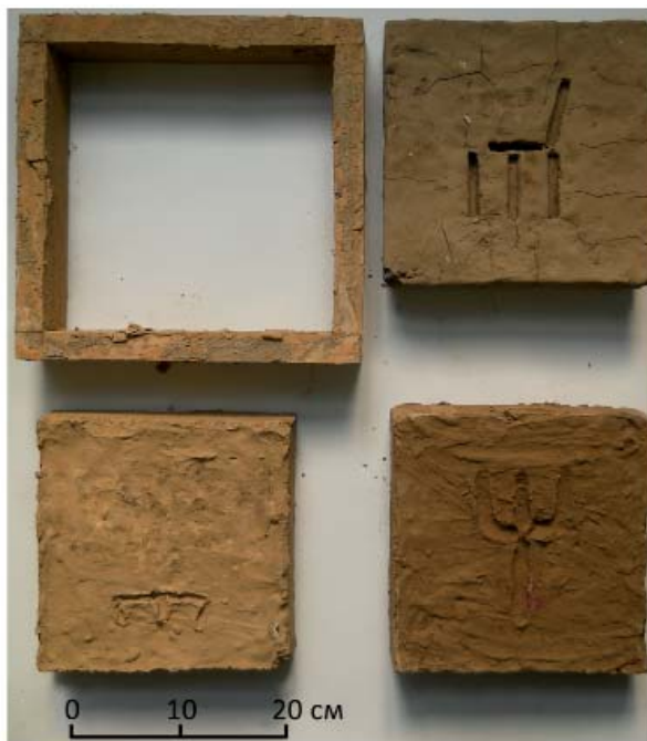
Рис. 2. Деревянная форма для набивки и высохшие полуфабрикаты. Хорошо видна разница в усадке при использовании разного теста.
