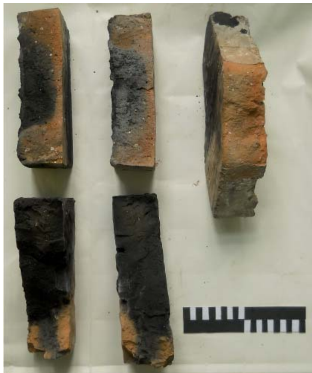
Рис. 6. Изломы экспериментальных кирпичей обожженных на костре. Fig. 6. Fractures of experimental bricks burnt in the open fire.
