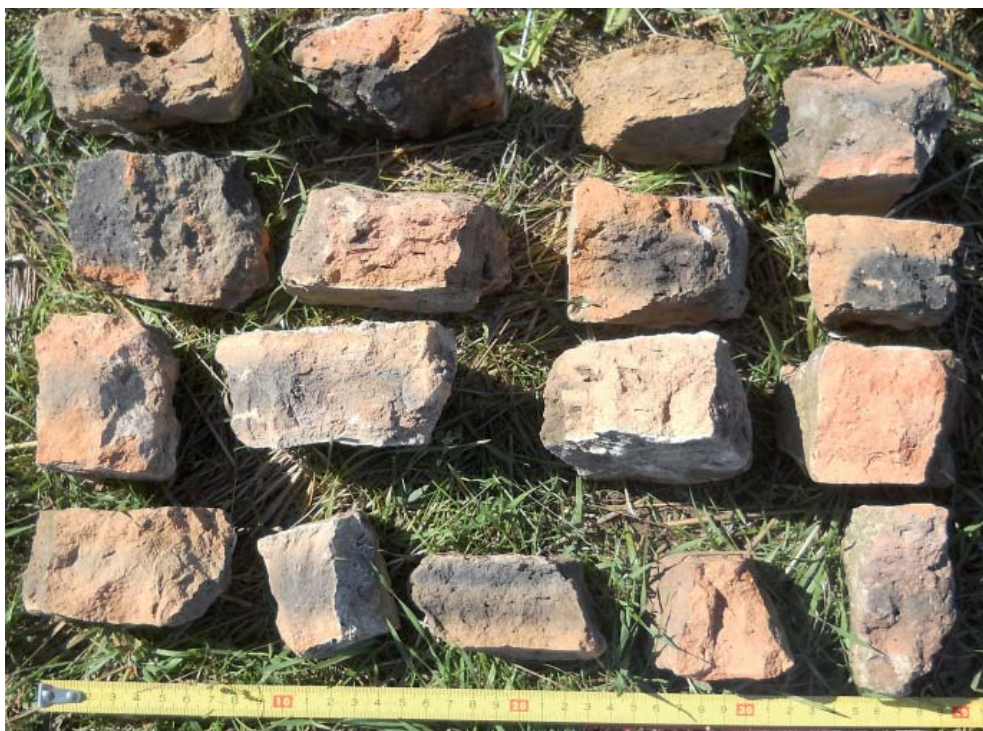
Рис. 8. Изломы кирпичей Семикаракорского городища. Fig. 8. Fractures of bricks from the Semikarakor hillfort site.
