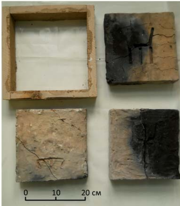
Рис. 5. Экспериментальные кирпичи обожженные на костре. Fig. 5. Experimental bricks burnt in the open fire.
