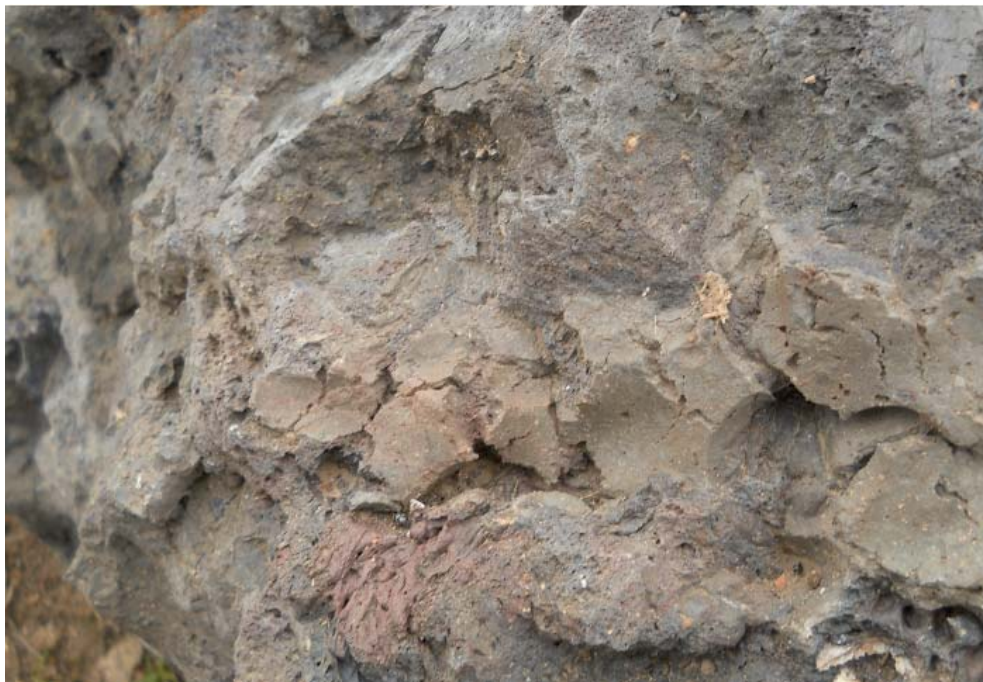
Рис. 7. Поверхность производственных кирпичей с дефектом «завар». Fig. 7. Surface of mass-production bricks with "scalding" (zavar).
