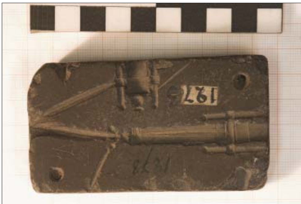
Рис. 6. Литейная форма для отливки деталей точных весов. Болгар. Коллекция В.И. Заусайлова. Фото К. Карпелана.
