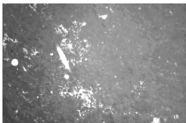
Рис. 5. Шлифы кремня (Камское Устье): а) полосчатого, б) с обломками фауны.
